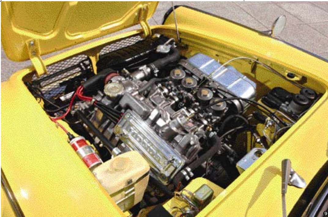
⑦車台プレートは、助手席側に装着。S800Mは末尾番号の下4桁が5で始まる。⑧Sシリーズには京浜製のCVキャブを採用。排気量や年式によって口径や形状が変更されている。S800Mには、30Hと30Jの2種類があり、このS800Mにはパイロットスクルーが垂直な30Jが装着されている。⑨点火系以外は、純正スペックでOHされたAS800E型エンジン。総アルミ製の2バルブDOHCエンジンは、まさに精密機械のようだ。
