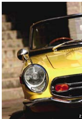
①ホイールはS800Mでは13インチが標準となり、ラジアルタイヤを採用。また、フロントキヤリバーはガーリングのフローティングタイプに変更され、制動力をアップ。②フロントグリル内のウインカーは国内仕様で、輸出仕様はやや大きく、デザインも異なる。
