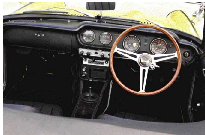
基本的なデザインはSシリーズと共通だが、S800Mではダッシュボードがパッド入りになるのが特徴。自動選曲ラジオ、大容量ヒーターが標準装備となった。純正ステアリングも美しい状態。
