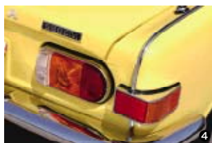
③トランクの横に設けられた給油口には、クラシカルなデザインのフタが取り付けられる。トランクのヒンジやモール類なども、新品のように磨き上げられている。④テールランプは白、オレンジ、赤色の3分割。国内仕様とアメリカ仕様がこのデザインだ。リアの角に装着されているリフレクターがS800Mの特徴。⑤トランクルーム内はもちろん、燃料タンクやヒンジなどもキレイにレストア済み。⑥トランク内の後方パネルには、ホイールレンチ兼用のジャッキ用の棒がセットされている。
