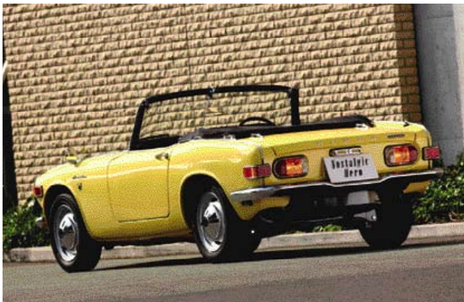
1966年5月のマイナーチェンジで、チェードライブから4リンク+派なールロードのリジッドアクスルに変更された。ドア後方からキックアップしたサイドビューが美しい。ラダーフレームとアウトースキンを組み合わせる構成となっている。
