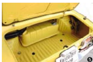
③トランクの横に設けられた給油口には、クラシカルなデザインのフタが取り付けられる。トランクのヒンジやモール類なども、新品のように磨き上げられている。④テールランプは白、オレンジ、赤色の3分割。国内仕様とアメリカ仕様がこのデザインだ。リアの角に装着されているリフレクターがS800Mの特徴。⑤トランクルーム内はもちろん、燃料タンクやヒンジなどもキレイにレストア済み。⑥トランク内の後方パネルには、ホイールレンチ兼用のジャッキ用の棒がセットされている。
