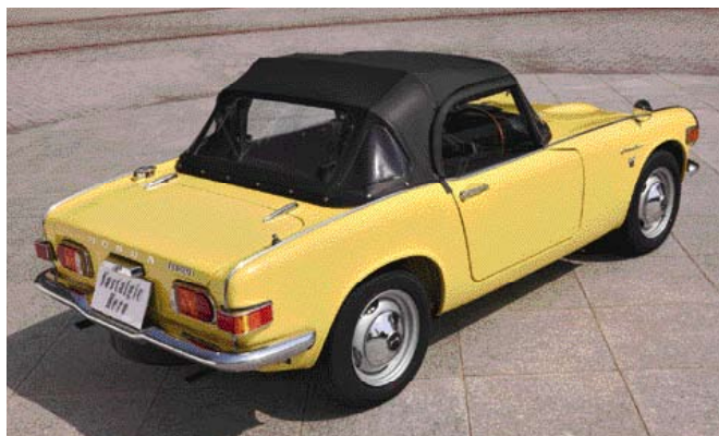
ソフトトップは、ガレージ イワサによって新品に交換されている。S800Mからは、従来型より幌骨から高くなっており、ヘッドクリアランスを稼いでいる。
