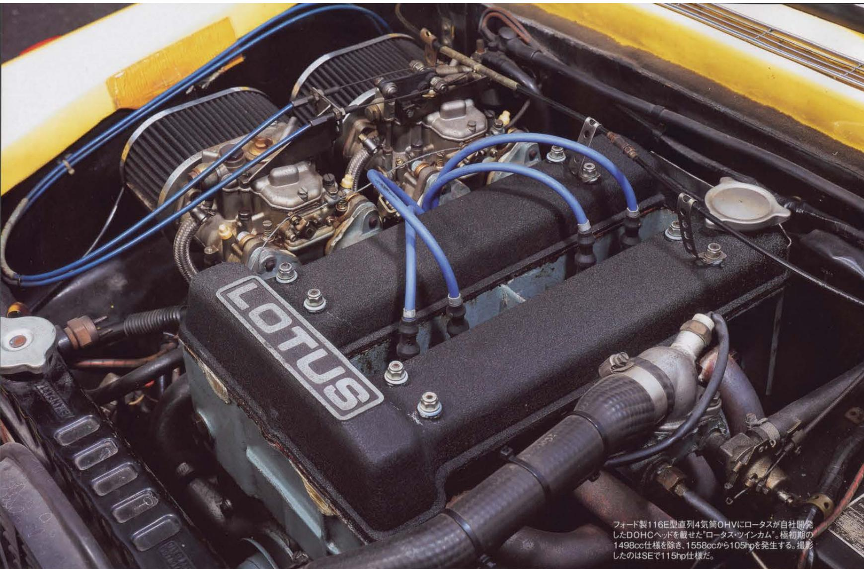
フォード製116E型直列4気筒OHVにロータスが自社開発したDOHCヘッドを載せた「ロータス・ツインカム」。極初期の1498cc仕様を除き、1558ccから105hpを発生する。撮影したのはSEで115hp仕様だ。
