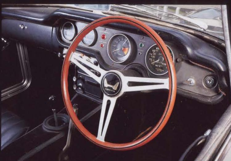
エリートの影響を感じさせるホンダ・エスのメーターパネルは当初のシルバーから、反射防止のためS800から黒く塗装されたものを採用する。S800のチェーンタイプまでのステアリングはフタバヤ製のウッドだったが、リヤがリジッドとされた時からABS樹脂製に変更された。シートは当時のセミバケットタイプ。撮影車は最終モデルのMタイプで珍しい英国仕様のクーペ。そのため前後のフェンダーに大型リフレクターを装備している。
