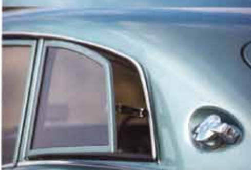
▶楕円形の台座に丸形ヘッドランプと異形スモールランプを組み合わせた独特のスタイル。ガレージワイフザによれば、この台座の角度が左右で異なる筐体も見受けられるという。ボンネットに大きなバルジを飾るのはS800だけだ。給油口がトランク蓋からCピラー上に移設されているのがクーペの特徴。クォーターウィンドウは内ヒンジで開閉可能。ハッチゲートを備えて荷物の出し入れを容易にしている。2本のダンパーは回転部分で締め付け具合を調整できる。
