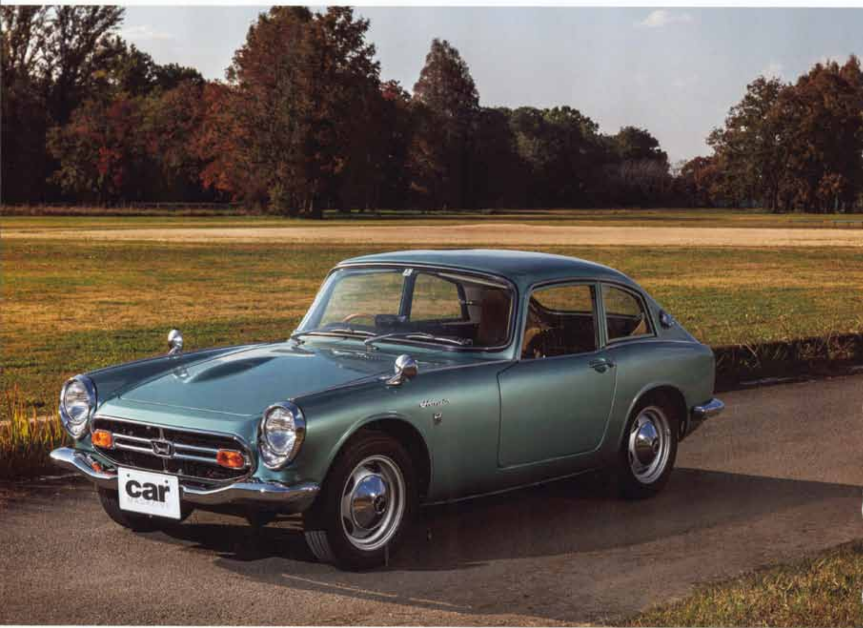
Sシリーズのハイライトが日本初のDOHCエンジン。オートバイメーカーらしく気筒ごとにひとつのキャブレターが備わり、インテークマニホールドの代わりにゴムのインシュレーターを採用する。大きなDOHCヘッドを抱えるエンジンは45°傾けて搭載されることも特徴で、低いボンネットを実現している。SB00の前駆まで続いたリアのトレーリングアームサスペンション、内部にチェーンとスプロケットを装備するのはオートバイの発想だ。
