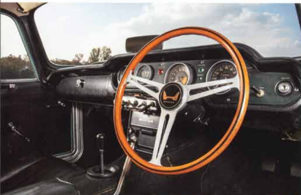
◀S500からS600までアルミだったメーターパネルはS800に進化しただけに反射を防ぐため黒く塗装された。4速の左上がリバースとなるシフトレバーは短いストロークでシフトチェンジが楽しめる。シートは左右が盛り上がるバケットタイプで、幅が狭い車内では十分以上のホールド性を実現している。シート後ろのトランクスペース左は燃料タンクのカバー。オープン前提の設計ゆえルーフミラーはダッシュボード上、後方視界は十分に確保されている。
