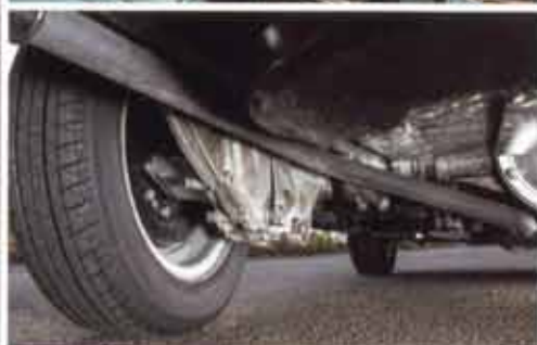
Sシリーズのハイライトが日本初のDOHCエンジン。オートバイメーカーらしく気筒ごとにひとつのキャブレターが備わり、インテークマニホールドの代わりにゴムのインシュレーターを採用する。大きなDOHCヘッドを抱えるエンジンは45°傾けて搭載されることも特徴で、低いボンネットを実現している。SB00の前駆まで続いたリアのトレーリングアームサスペンション、内部にチェーンとスプロケットを装備するのはオートバイの発想だ。
