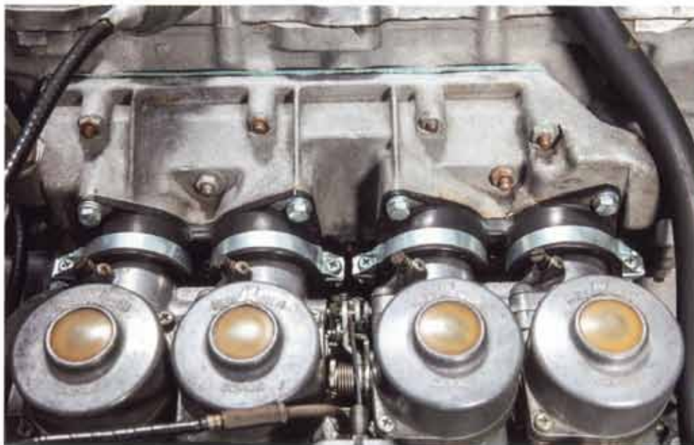
Sシリーズのハイライトが日本初のDOHCエンジン。オートバイメーカーらしく気筒ごとにひとつのキャブレターが備わり、インテークマニホールドの代わりにゴムのインシュレーターを採用する。大きなDOHCヘッドを抱えるエンジンは45°傾けて搭載されることも特徴で、低いボンネットを実現している。SB00の前駆まで続いたリアのトレーリングアームサスペンション、内部にチェーンとスプロケットを装備するのはオートバイの発想だ。
